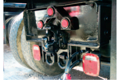
Pintle Hitches 8 Ton Combo up to 50 Ton Rigid
